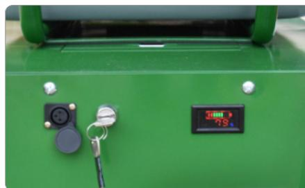
Übersichtliche Bedienarmatur mit Schlüssel, Ladebuchse und LED-Display mit Ladestandsanzeige
