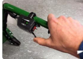
Daumenhebel für eine stufenlose Einstellung der Geschwindigkeit
