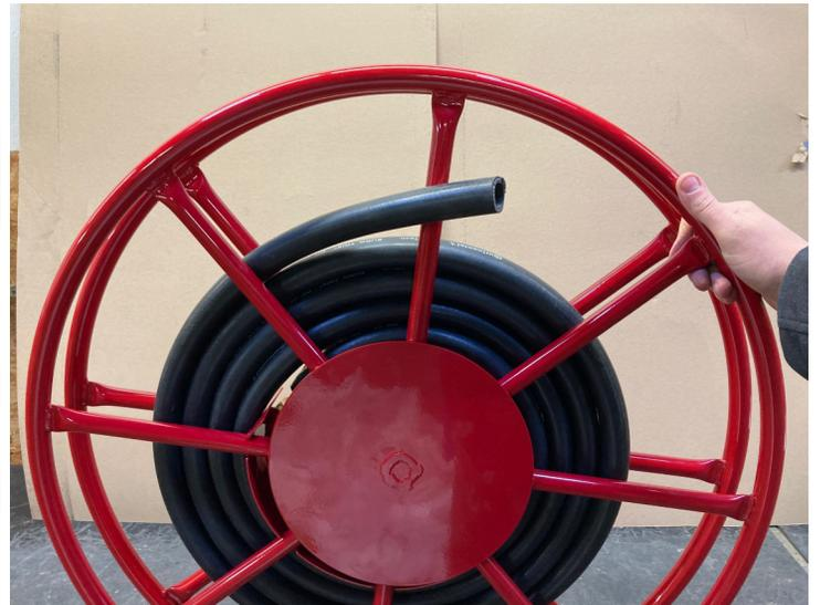
4. Trommel im Uhrzeigersinn 3 Umdrehungen vorspannen, dabei darauf achten, dass die Trommel anschließend fest fixiert wird.und nicht unkontrolliert zurückrollt.
